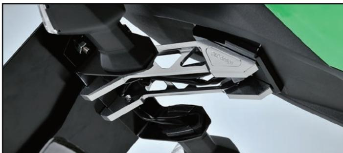
メインプレートはカウル内部への水や、ホコリの侵入を極力防ぐ形状にし、車体に取り付けた際の配線の処理も考え設計しました。
