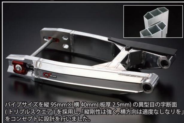
パイプサイズを縦95mm×横40mm(板厚2.5mm)の異型目の字断面(トリプルスクエア)を採用し、「縦剛性は強く、横方向は適度なしなりを」をコンセプトに設計を行いました。
